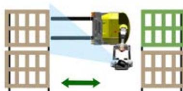
Debout sur le côté de du gerbeur, on élimine le risque d'être piégé ou écrasé tout en permettant au Combi-CS de fonctionner dans des allées très étroites.
